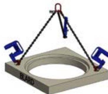
Système de levage prévu à la fabrication.
