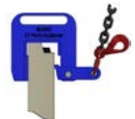
La pince de levage n'est pas en contact avec le joint TRI 5 ; il peut donc être mis en place en haut de tranchée avant la mise en œuvre de l'élément.
