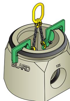
Outil de levage adapté pour une mise en œuvre facilitée en toute sécurité
