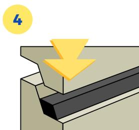
**L'écrasement du joint, obtenu par une pression d'une minute au moins, est nécessaire avant remblaiement, pour assurer l'étanchéité de l'assemblage.**
