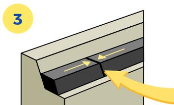
**Le raccordement des cordons de joint doit se faire bout à bout pour éviter tout recouvrement. Soudure par modelage.**
