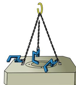
Système de levage prévu à la fabrication.
