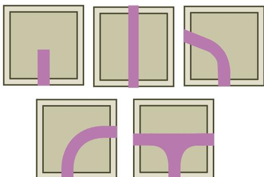
Le joint souple intégré permet des déviations angulaires de 25 à 40° selon Ø, tout en conservant ses performances d'étanchéité.
