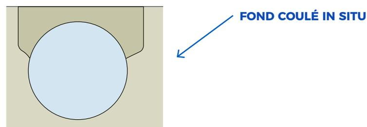
Certains ouvrages spéciaux et tout particulièrement des éléments de fond sur tuyaux de gros diamètres, peuvent être coulés sur place.
