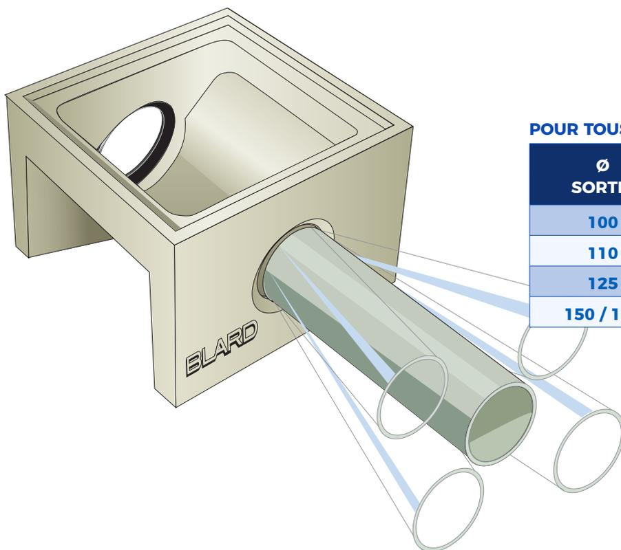
Le joint souple intégré permet des déviations angulaires de 25 à 40° selon Ø, tout en conservant ses performances d'étanchéité.
