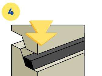
**L'écrasement du joint obtenu par une pression d'une minute au moins, est nécessaire avant remblaiement, pour assurer l'étanchéité de l'assemblage.**
