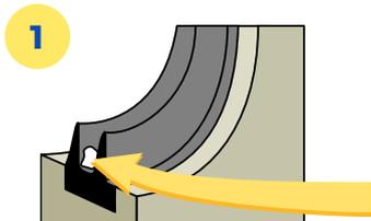
**Avant d'emboîter le tuyau bien s'assurer qu'aucune impureté ne s'est glissée dans le joint. Graisser le tuyau. Éliminer.**
