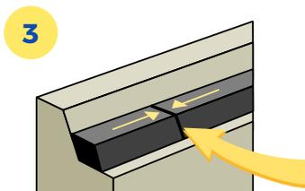
**Le raccordement des cordons de joint doit se faire bout à bout pour éviter tout recouvrement. Soudure par modelage.**
